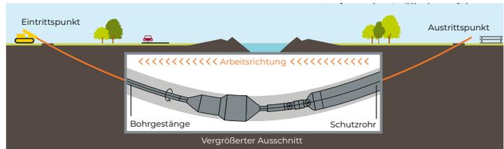
Schematische Darstellung einer geschlossenen Unterquerung mittels Horizontalem Spülbohrverfahren.
